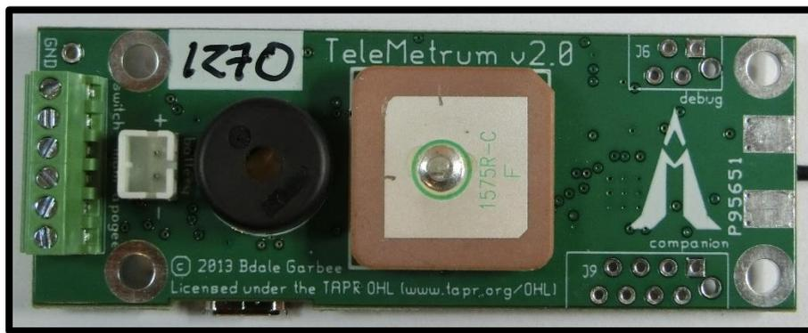
**Figure 31: TeleMetrum v2.0 Altimeter.**
