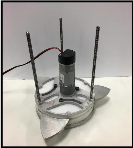
**Figure 14: VDS prototype.**
