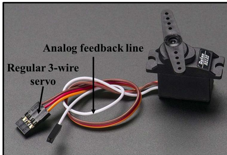
Figure 66. Batan analog feedback servo.
